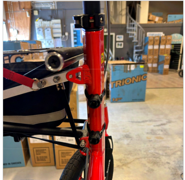
6 Oba uchwyty prawidłowo zamontowane na rurze ramy.
