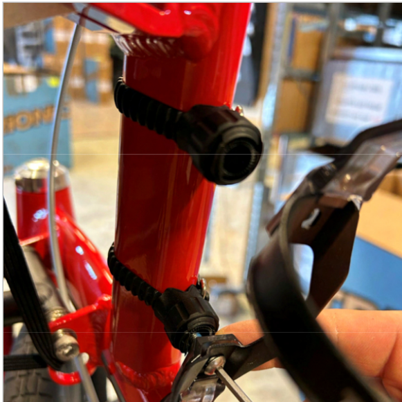
7 Przymocuj uchwyt na butelkę za pomocą dwóch śrub. „Otwór” uchwyty na butelkę powinien być skierowany na zewnątrz.
