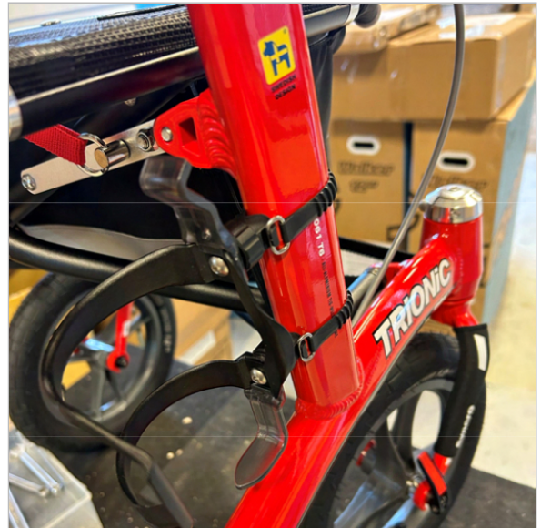
8 Uchwyt na butelkę jest teraz przymocowany do ramy. Butelkę wkłada się z boku i wyjmuje na zewnątrz.
