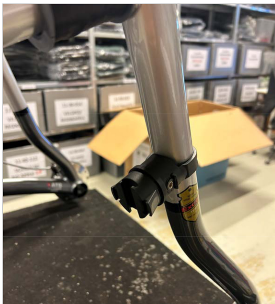
⑧ Zdjęcie przedstawia prawidłowe zamocowanie uchwytu.
